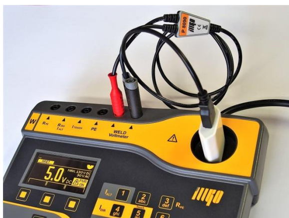
P 8090 – adaptér pro testování zdrojů SELV s USB konektorem (napětí, dotykový proud, izolační odpor)
