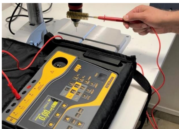
P 3070 – sonda pro snímání dotykového proudu z rotujících částí spotřebičů
