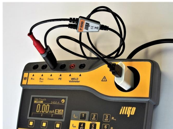
P 8090 – adaptér pro testování zdrojů SELV s USB konektorem (napětí, dotykový proud, izolační odpor)
